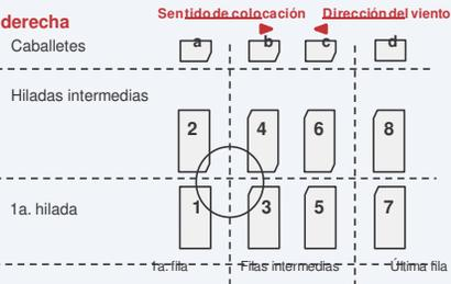
Las tejas Sevillanas tienen un solo sentido de colocación (de izquierda a derecha). Su colocación debe iniciarse de abajo hacia arriba, en el orden indicado.
