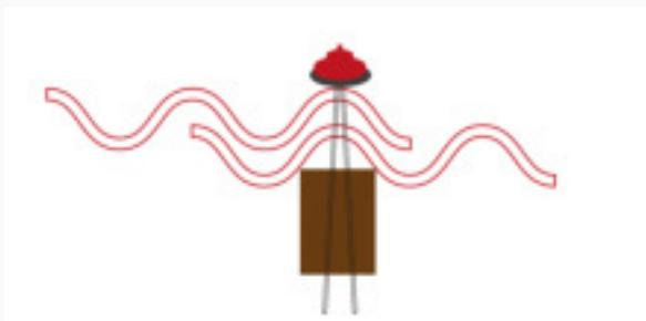
Se debe colocar amarres metálicos, que tengan capuchón para evitar la filtración del agua preferiblemente realizando la apertura con taladro para la instalación de los mismos.
